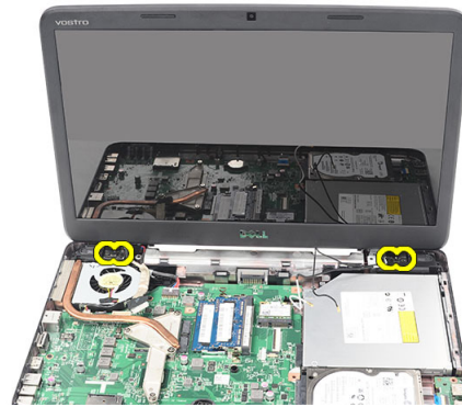
6. הרם כלפי מעלה את מכלול הצג והסר אותו מהמחשב.
